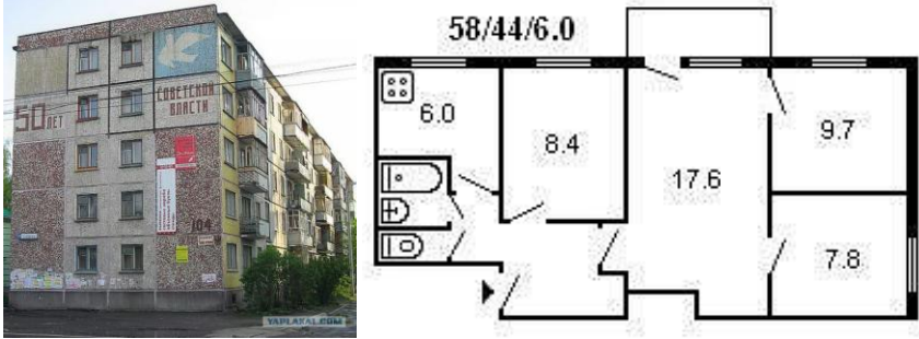
Рис. 19.1-1. Дом серии 1-335А-2 и план 4-комнатной квартиры в нём. Они размещались в торцах здания со стороны, противоположной подъездам. На плане квартира противоположного торца
